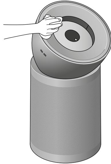
Verificare la presenza di detriti nei sensori di ingresso dell'aria sul lato sinistro dell'amplificatore conico.
