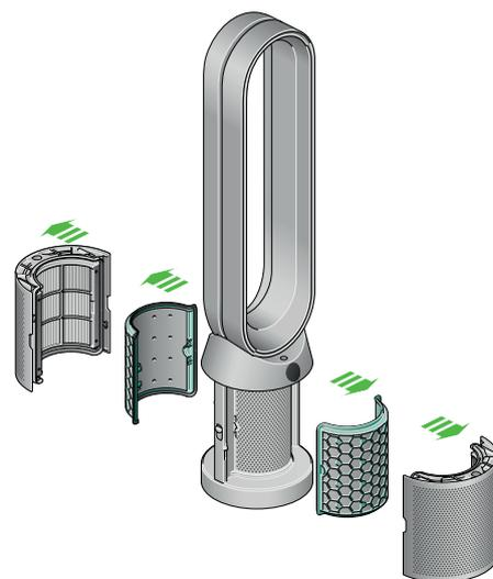
Il purificatore ventilatore con le coperture del filtro aperte, un filtro HEPA visibile al loro interno e un filtro a carboni attivi. Le frecce indicano che il filtro a carboni attivi va montato direttamente sulla base dell'apparecchio e le coperture del filtro dovranno essere assemblate sulla base dell'apparecchio.
