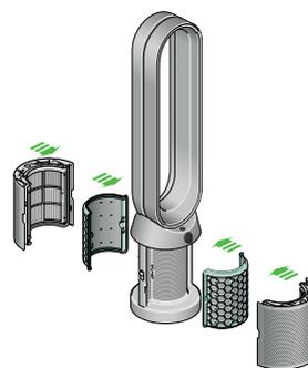
Il purificatore ventilatore con le coperture del filtro aperte, un filtro HEPA visibile al loro interno e un filtro a carboni attivi. Le frecce indicano che il filtro a carboni attivi va montato direttamente sulla base dell'apparecchio e le coperture del filtro dovranno essere assemblate sulla base dell'apparecchio.
