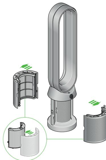
Il purificatore ventilatore con le coperture del filtro aperte e il filtro HEPA + Carboni attivi visibile al loro interno. Le frecce indicano che le coperture del filtro dovranno essere assemblate sulla base dell'apparecchio.
