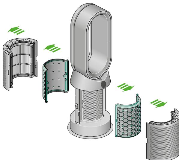
Il purificatore termoventilatore con le coperture del filtro aperte, un filtro HEPA visibile al loro interno e un filtro a carboni attivi. Le frecce indicano che il filtro a carboni attivi va montato direttamente sulla base dell'apparecchio e le coperture del filtro dovranno essere assemblate sulla base dell'apparecchio.
