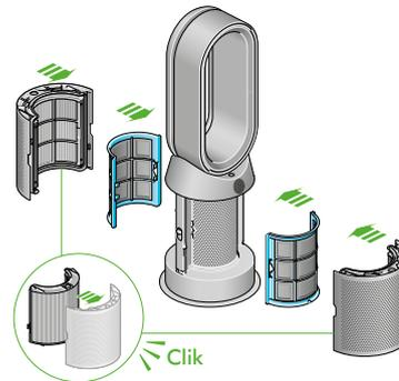
Il purificatore termoventilatore con le coperture del filtro aperte, un filtro HEPA + Carboni attivi visibile al loro interno e un filtro catalitico. Le frecce indicano che il filtro catalitico va montato direttamente sulla base dell'apparecchio e le coperture del filtro dovranno essere assemblate sulla base dell'apparecchio.
