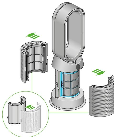
Il purificatore termoventilatore con le coperture del filtro aperte, un filtro HEPA + Carboni attivi visibile al loro interno e un filtro catalitico. Le frecce indicano che il filtro catalitico va montato direttamente sulla base dell'apparecchio e le coperture del filtro dovranno essere assemblate sulla base dell'apparecchio.
